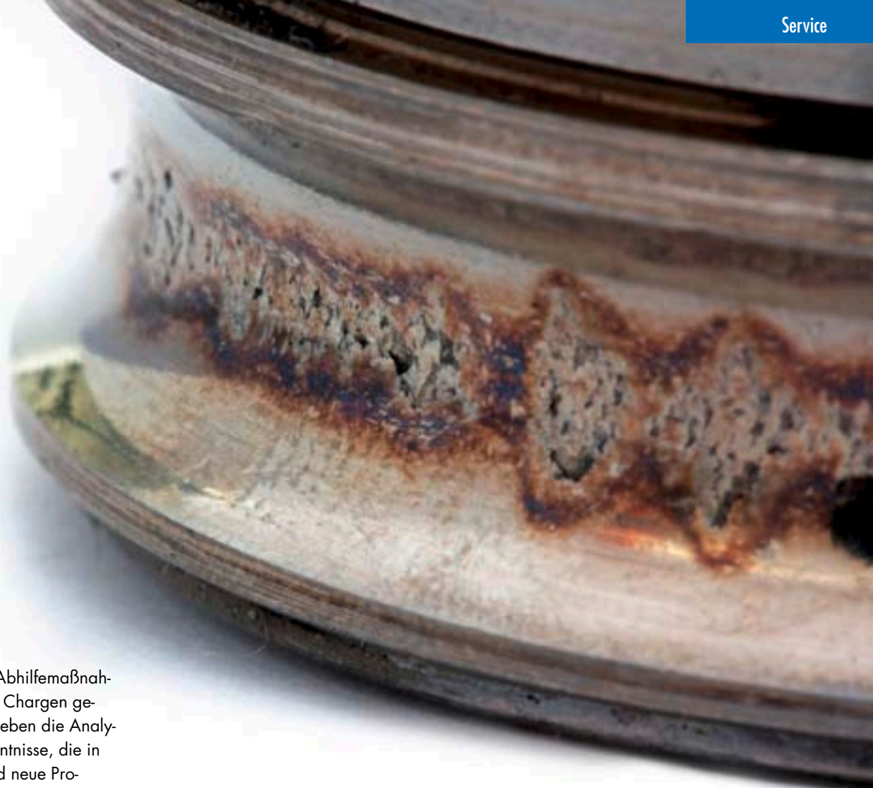
Bild 3: Nicht vorhandene Schmierung von Kugellagern führte zum Schadensfall.
